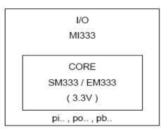
2. Core:3.3V & I/O 5V-Tolerant ( need 5V PowerPad )
